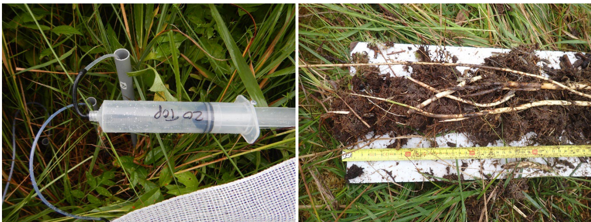
Figuur 3.15. Bemonstering van porievocht met een ceramische cup op locatie 20 (links). Bemonsterde toplaag op locatie 35 met zichtbaar de rietwortels in het bodemprofiel (rechts).
