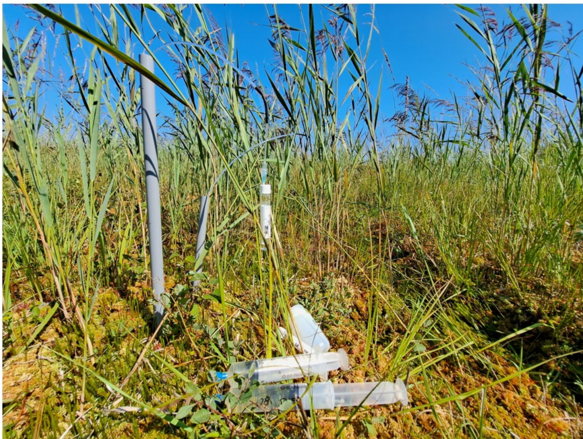
Figuur 2.6. Bemonstering van het porievocht in de wortelzone op een van de onderzoeklocaties.
